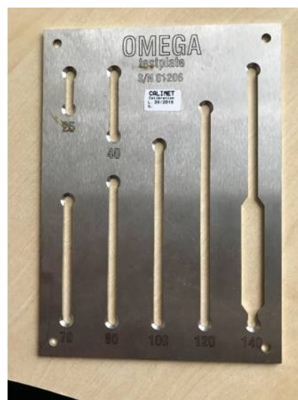
Figur 3. Venstre bilde: Måling av notlinet i en av forsøksposene med en Omega maskemåler. Høyre bilde: Kalibreringsplate for Omega-måleren.
