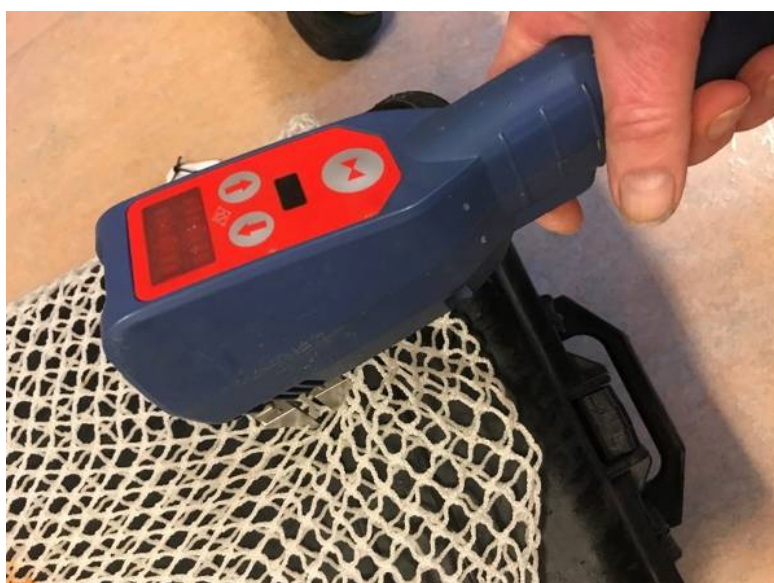
Figur 3. Venstre bilde: Måling av notlinet i en av forsøksposene med en Omega maskemåler. Høyre bilde: Kalibreringsplate for Omega-måleren.
