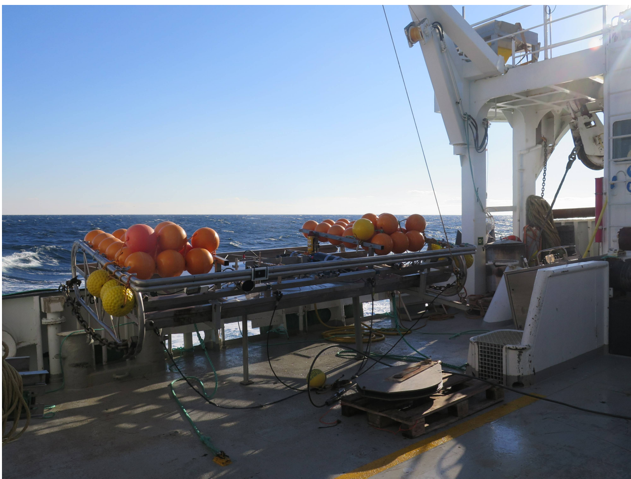
Figur 1. Videorigg med kamera, lys og lasere på vugge styrbord side.
