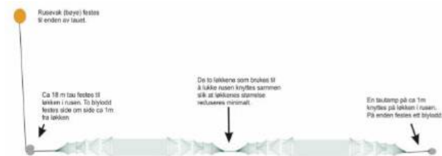
Figur 27. To doble åleruser satt sammen til en lenke (fra van der Meeren et al., 2021. Sluttrapport fra ICOD-prosjektet. Arbeidspakke 2: Egg- og yngelundersøkelser på gyte- og oppvekstområder på Smøla og i Aure i forbindelse med etablering av oppdrettsanlegg nær lokale gyteområder for kysttorsk. Rapport fra Havforskningen Nr. 2021-32).
