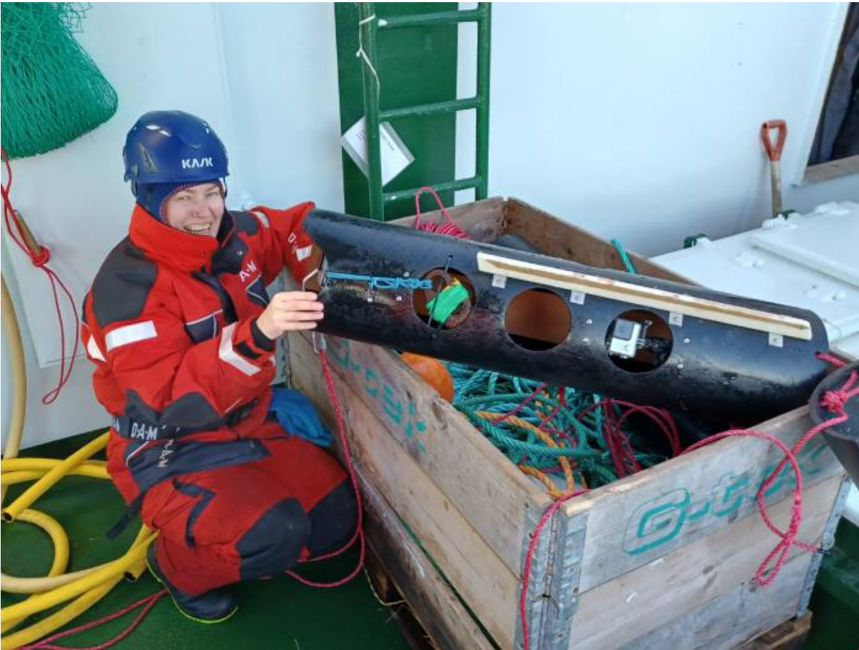
Figur 3. Liz monterer kamera bakerst på flygeren. Midt på bildet ser vi et improvisert lodd (G-krok) for å stabilisere flygeren. Gjennom hullene ser vi Divinicell planke langs rørets overkant som sørger for oppdrift. Lengst til høyre ser vi en kite som er knytt til selve flygerøret med rødt tau.
