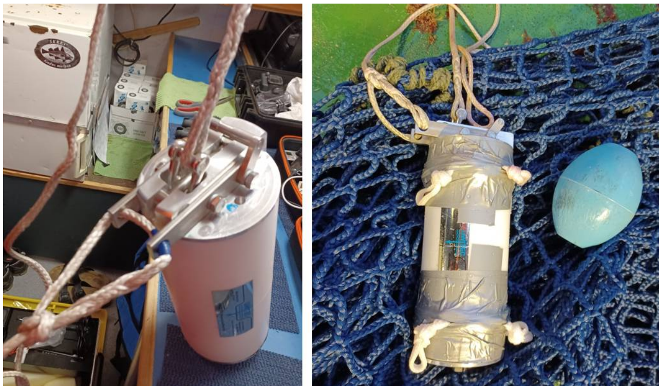
Figur 20. Uwitec utløseren etter modifisering. Til venstre ser vi hvordan gropen for utløsesjakkell har vært forstørret slik at den kan trekkes sideveis. Til høyre ser vi improviserte «festeører», hvor taustopper er tapet på med lerretstape.
