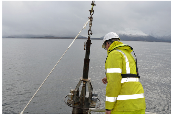
Figur 7.9: Grabbprøver på FF «Seisma» under kystnær kartlegging. Foto: NGU.
