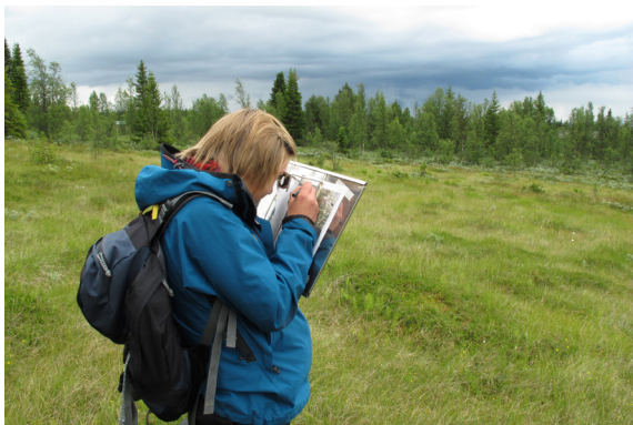
Figur 7.1: Tradisjonell kartlegging med fløy og analoge flybilder i 3D. Fra kartlegging av Gravfjellet i Valdres. Foto: Anders Bryn, 2010.
