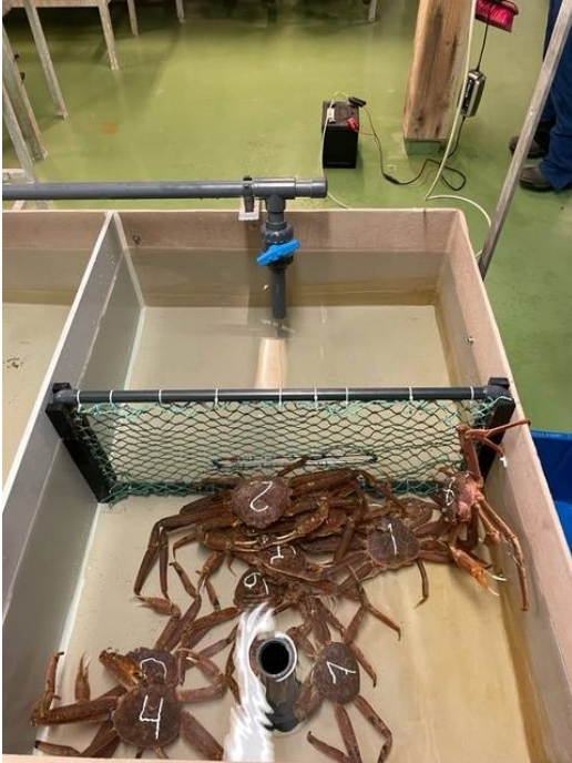
Figur 3.6 Testkammer montert med panel i finmasket notlin utstyrt med 38 mm fluktåpning.
