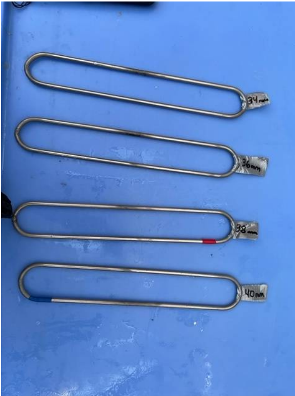
Figur 3.7 Fluktåpninger med 34-40 mm spaltehøyde.
