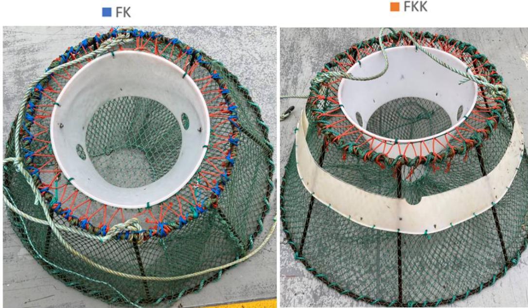
Figur 3.14 Finmaskede teiner med og uten en 12 cm høy krage ble sammenlignet.
