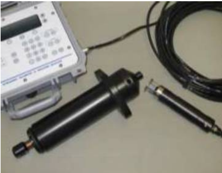
Figur 5.2 Dekksehnet koblet til ledning og hydrofon og Ar-2 (utløser) som ble bygd inn i undervannsbøyen.
