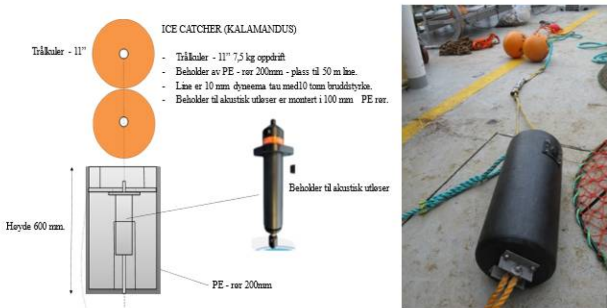
Figur 5.1 Venstre: Prinsippskisse undervannsbøye med akustisk utløser. Høyre: Bilde av IceCatcher systemet.
