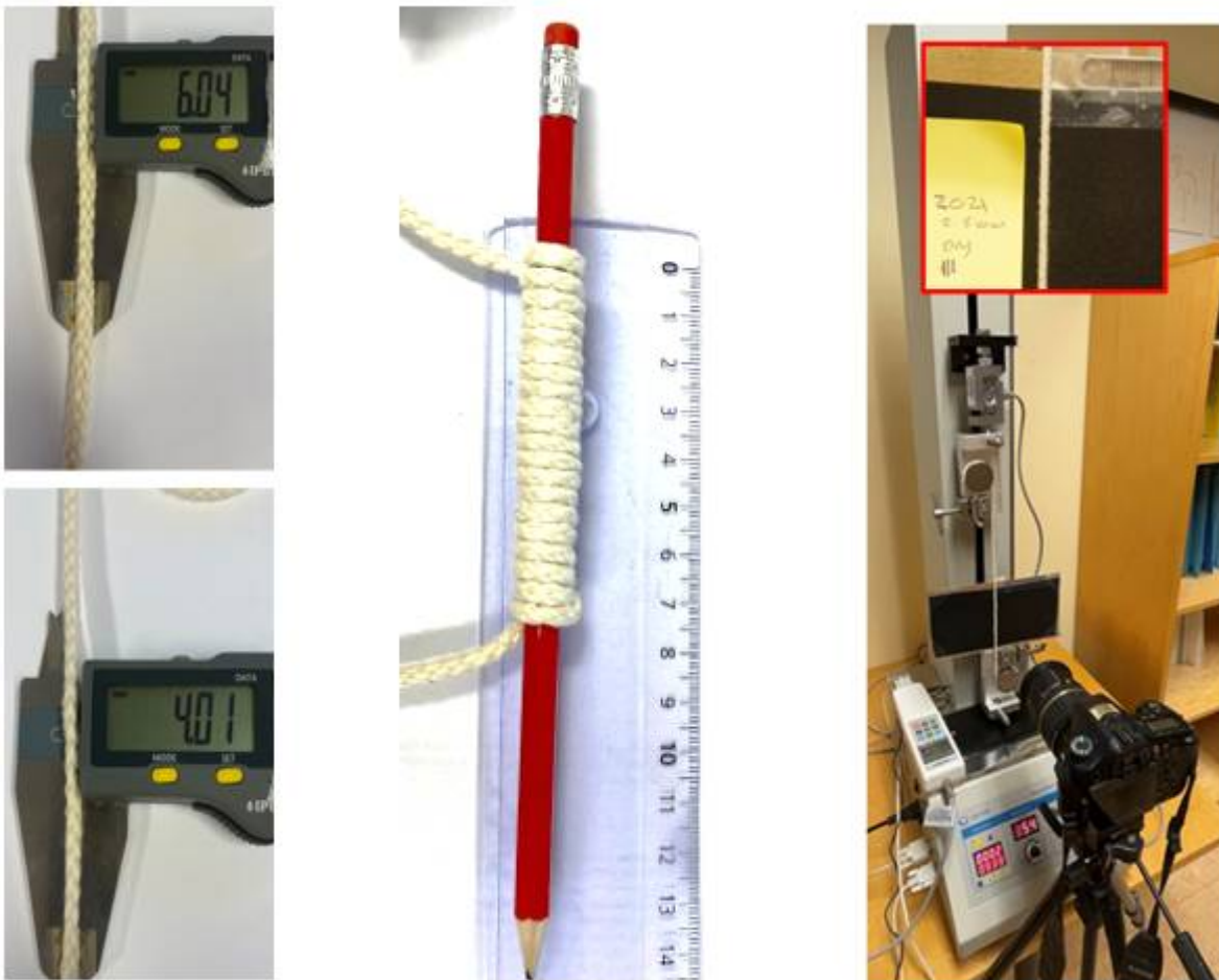
Figur 4.2 . Ulike metoder for måling av tråddykkelse (diameter). Skyvelæremetoden er enkel, men har åpenbart en del usikkerhet knyttet til hvor stramt tråden er strukket og hvor hardt den er presset mot målegapet på skyvelæret. Med skyvelære er det også viktig å måle fra ulike sider om tråden ikke er rund. Eksempelet viser måling av tråd nr. 6 (5 mm), en tråd med tilnærmet rektangulært tverrsnitt. Blyantmetoden med 20 surringer er også en enkel metode, men som for skyvelære vil det uten ytterligere standardisering være variasjon i hvor stramt tråden strekkes under surringen og hvor tett omgangene legges på blyanten. Optisk måling under standardisert strekk anses som den mest objektive metoden, men også den mest tid- og utstyrskevende.
