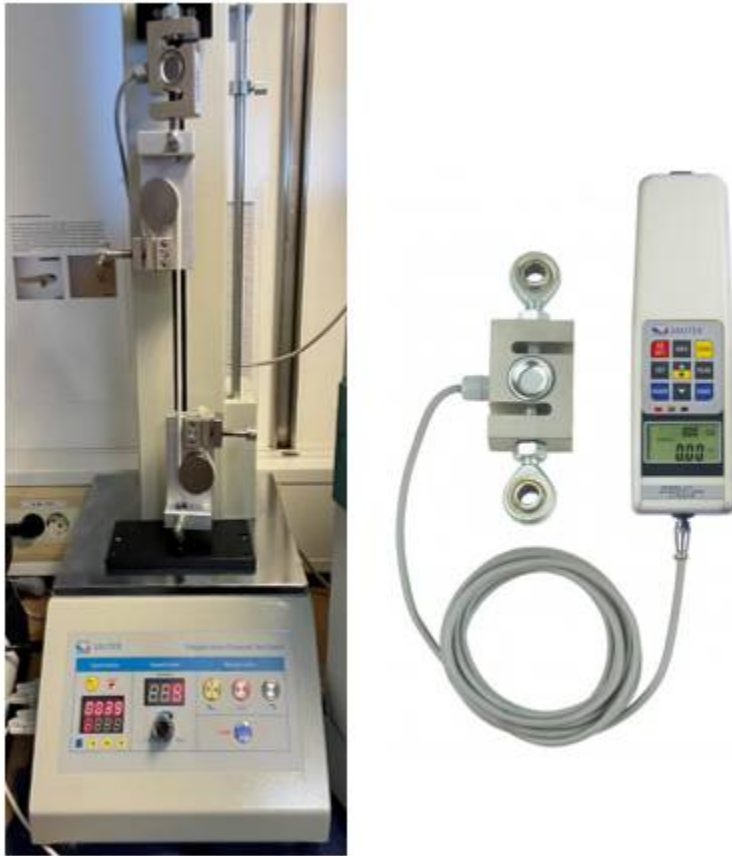
Figur 4.7 Elektrisk strekkcelle med steppermotor, spesifikt laget for testing av strekk og bruddstyrke. Her ble det montert samme tensiometer som på den hydrauliske strekkcellen benyttet i 2021.
