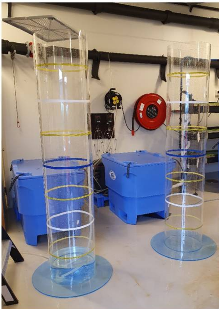
Figur 7. Sylindere brukt til synkeforsøk med reker.
