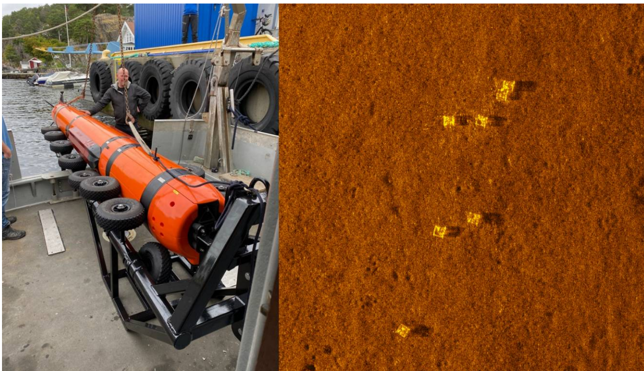
Figur 13: AUVen Munin+ rigget om bord på Tyra (venstre). Utsnitt fra kartlegging med HISAS viser en lenke med teiner på 90 meters dyp i Raet nasjonalpark(høyre). Teinene ble verifisert med ROV og berget.
