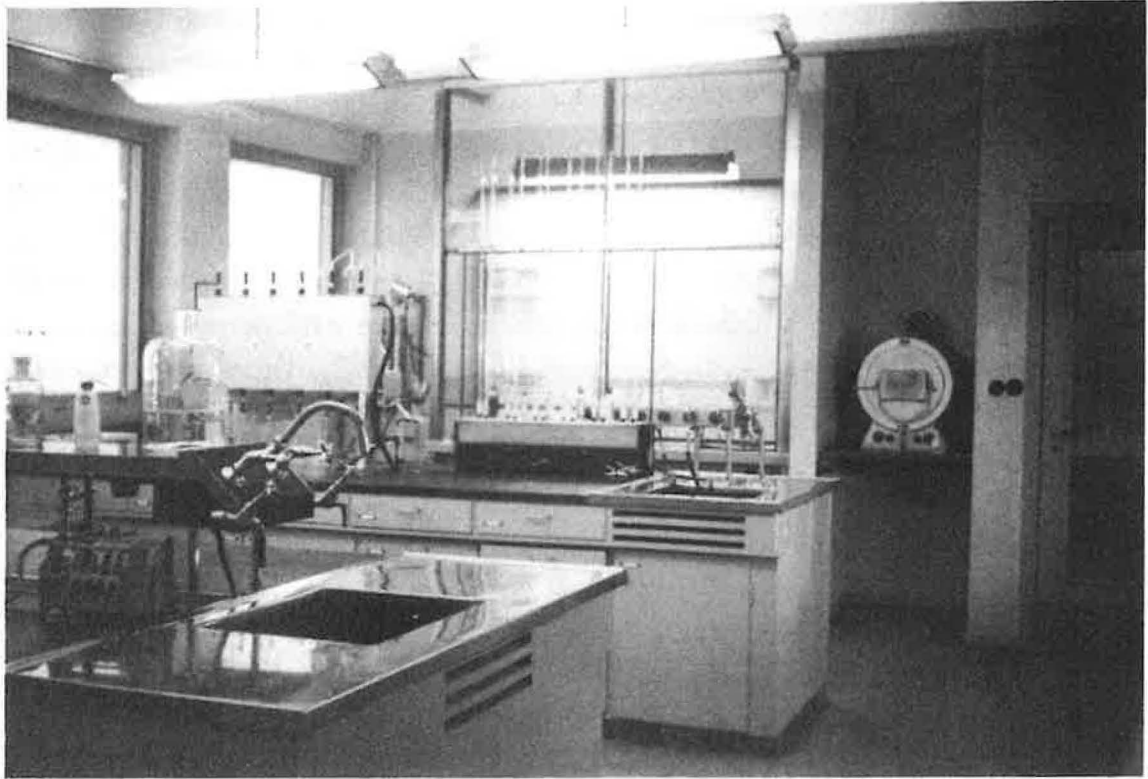
Interiør fra Lab. A i Lars Hillesgt 26. I avtrekket er det utstyr for Kjeldahl oppslutninger for nitrogenanalyse (proteinbestemmelse), nærmest avtrekket destillasjonsapparater der nitrogen som ammonium ble destillert over i et forlag med saltsyre.
