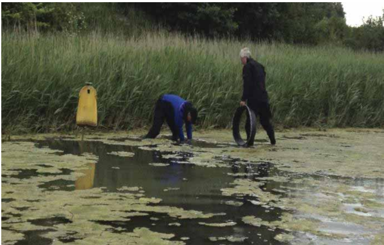
Figur 39. Utsetting av forsøksringer på grunt vann for uttesting med børstemark. Karl Norling (NIVA) og rithjof Moy (HI).
