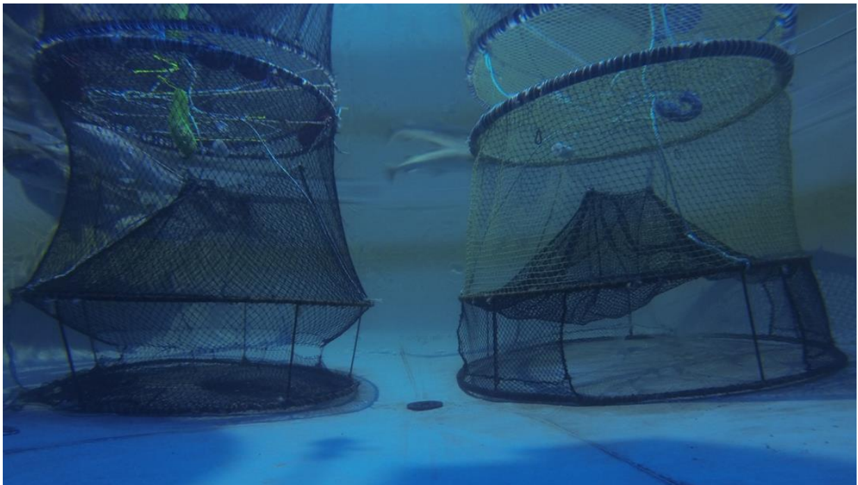
Bilde 10 Innomar-Original til venstre og Innomar-HI til høyre. Som man kan se så er kalvlinet i Inn-O mye strammere enn på Inn-HI.
