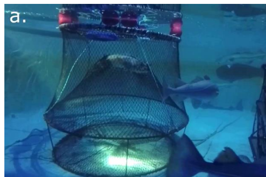
Bilde 6 Torsk som er gått seg fast i kalvåpning og som går inn i fangstkammer med ryggen først.
