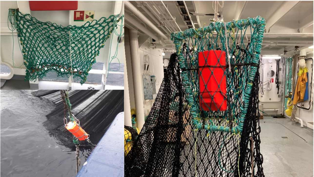
Figur 6. Montering av sensor i nota. I tidlige forsøk ble sensoren under flåen montert i en pose av notlin og kjetting under som vekt (bilde oppe til venstre). Denne ble videre utviklet til en liten robust stålramme med notlin og sensoren ble godt festet inni rammen som var enkel å montere av og på (bilde til høyre). Sensorer ble også festet i snurperingene først med kjetting fra de fire hjørnene til hanefoten (bilde nede til venstre) så i senere forsøk i en lignende ramme som sensoren under flåen for mer stabilitet.
