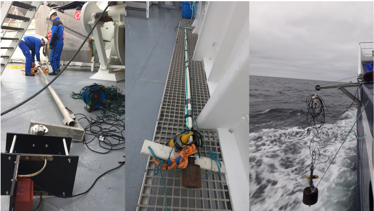
Figur 4. Ulike løsninger for montering av portable hydrofoner som ble senket ned fra babord side til 7 – 12 m dybde. Venstre: stang med pan and tilt unit og nohydrofon; Midten: stang med omnihydrofon; Høyre: elektrisk vinsj montert på rekkverket og omnihydrofon, blylodd ble brukt for å hindre avdrift på grunn av strøm.
