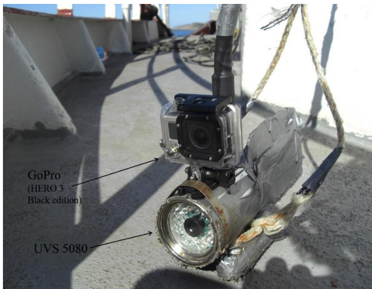
Figur 3. Undervannskamera benyttet til videoundersøkelser i Nordland.
