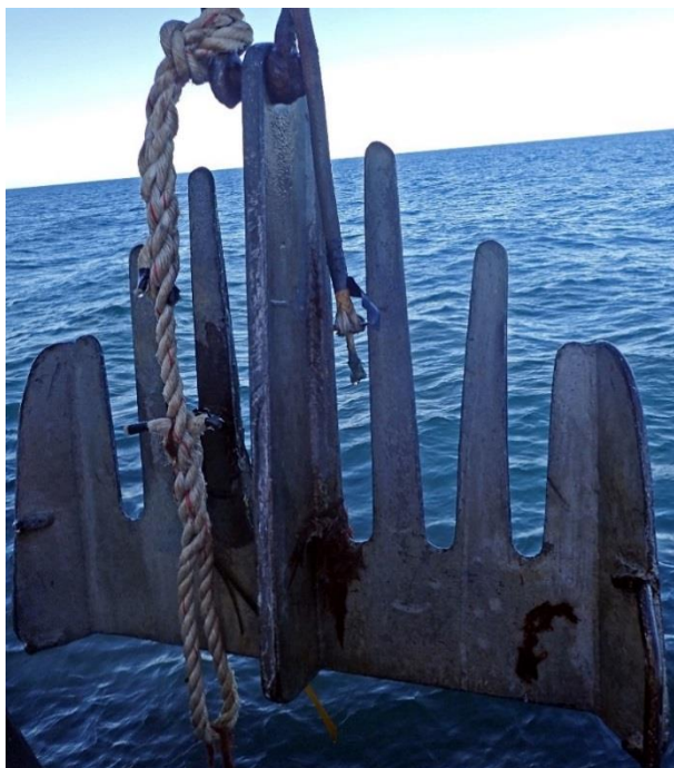
Figur 5. Tareskraper i stål (ca 60 cm bred) benyttet til innsamling av stortareplanter i Nordland i 2018.
