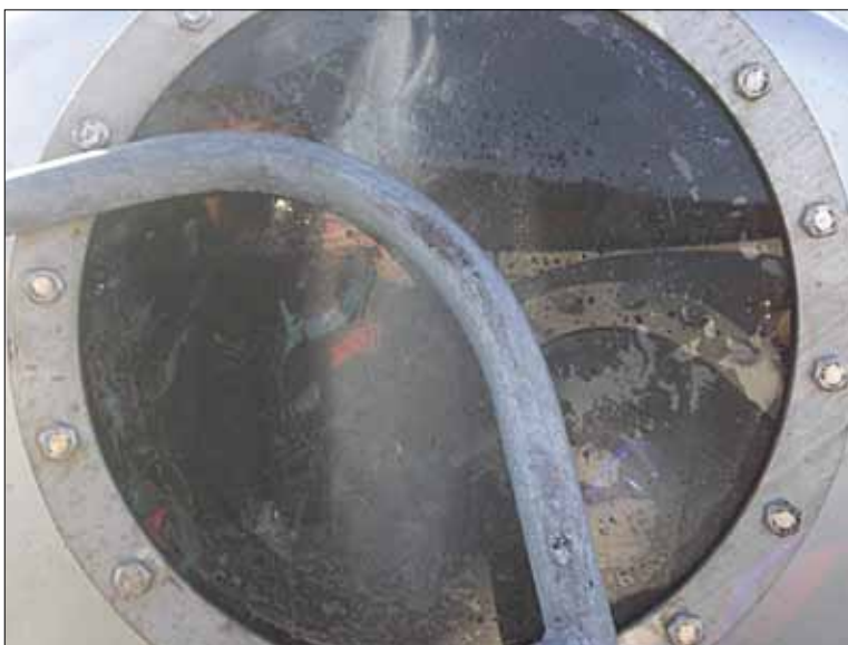
Figur 1.2-4. Fiskens atferd i pumpen kan observeres. Det bør ikke være for mye panikkatferd i pumpen, og det skal ikke ses rødt vann (blodvann).
