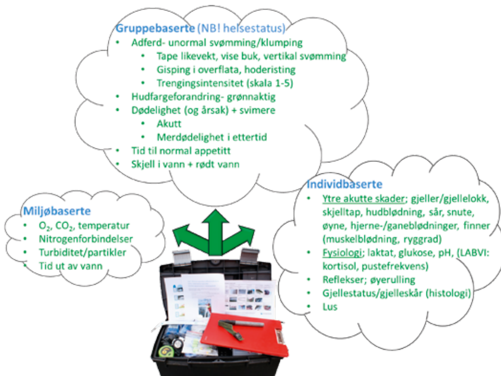
Figur 2.1-2. «Verktøykasse» med noen relevant OVI-er og LABVI-er for ny teknologi som involverer håndtering av fisk. Uttesting av ny teknologi bør utføres på fiskegrupper med kjent helsestatus, fortrinnsvis frisk fisk (Illustrasjon: K. Gismervik). Gjengitt med tillatelse fra K. Gismervik
