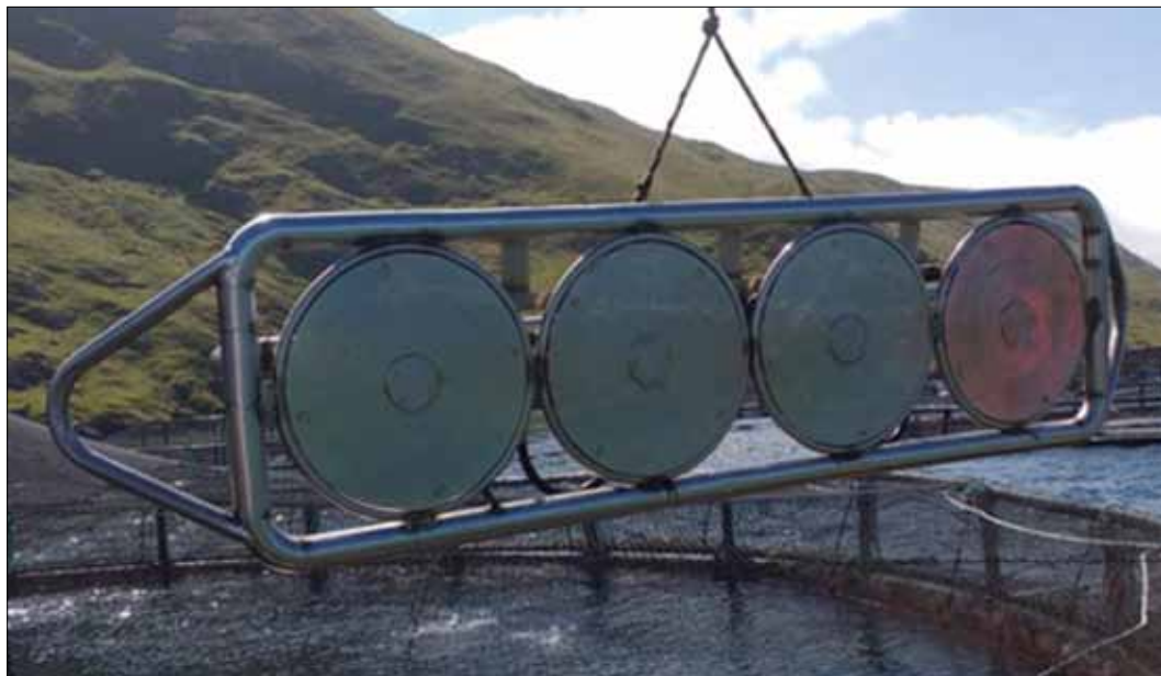
Figur 2.2.4-1. Eksempel på en notrengjøringsrigg fra AKVA med 4 rengjøringshoder. (Foto gjengitt etter tillatelse av N. Ribeiro, 2016).
