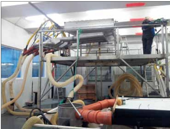
Figur 1.2-1. Rør-bøy kan forårsake skade på fisken. (Foto: Å. M. Espmark)
