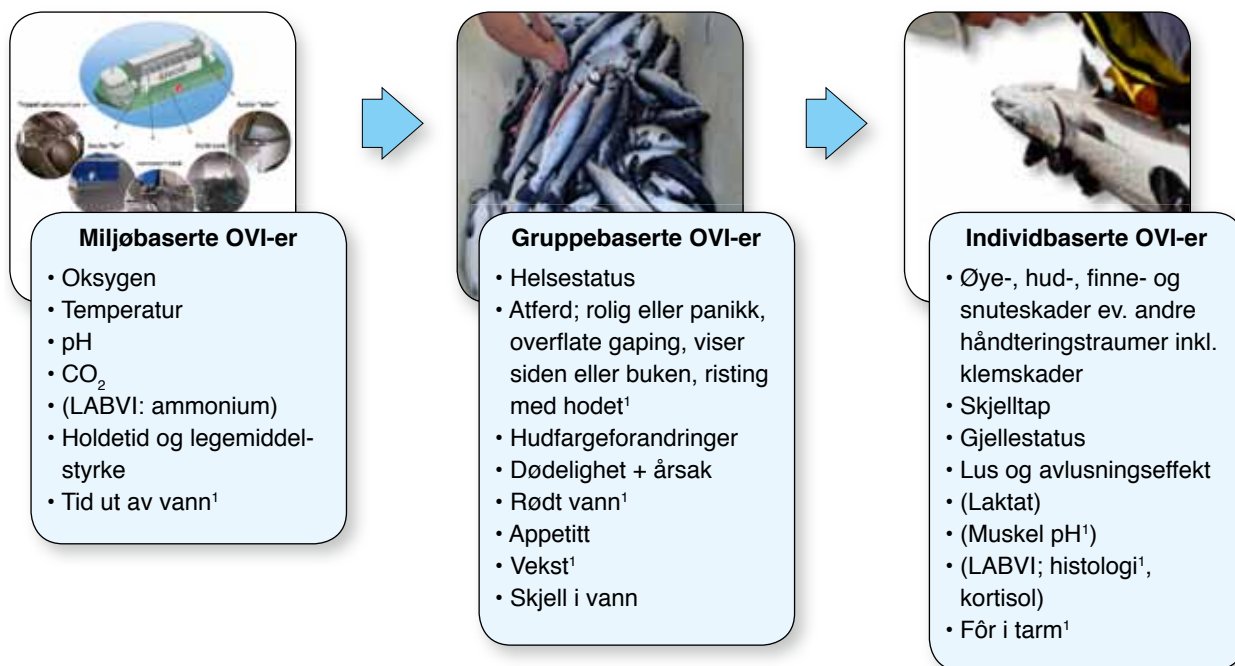
Figur 2.2-2. Oversikt over OVI-er og noen LABVI-er som kan være egnet i forbindelse med behandlingsflåter. Miljøbaserte OVI-er gjelder oppdrettsmiljøet og miljøet i teknologien, gruppebasert OVI-er handler om oppdrettspopulasjonen, mens individbaserte OVI-er angår enkeltindividet. 1 Basert på generell kunnskap, og er ikke nærmere beskrevet i velferdsdokumentasjonen som foreligger. OVI-er i parentes er mest aktuelle i utviklingsfasen eller som stikkprøver. (Illustrasjon og foto: K. Gismervik)
