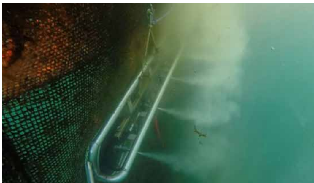
Figur 2.2.4-2. Eksempel på en notrengjøringsrigg fra AKVA med 4 rengjøringshoder under bruk. (Foto gjengitt etter tillatelse av N. Ribeiro, 2016).
