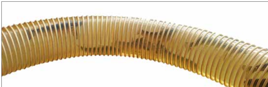
Figur 1.2-3. Smoltens atferd under pumping kan overvåkes gjennom den gjennomsiktige slangen. (Foto: Å. M. Espmark)
