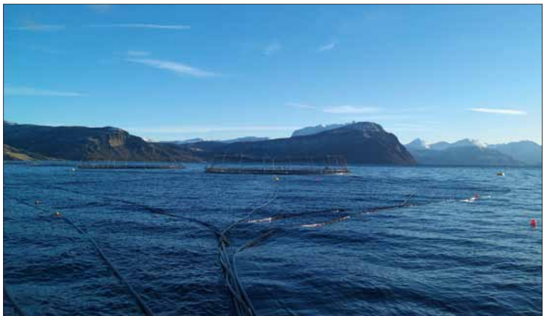
Figur 1.9-1. Sentralfôringsystem med fôringsrør som går fra en sentral fôrflåte til kommersielle oppdrettsmerder. (Foto: C. Noble)
