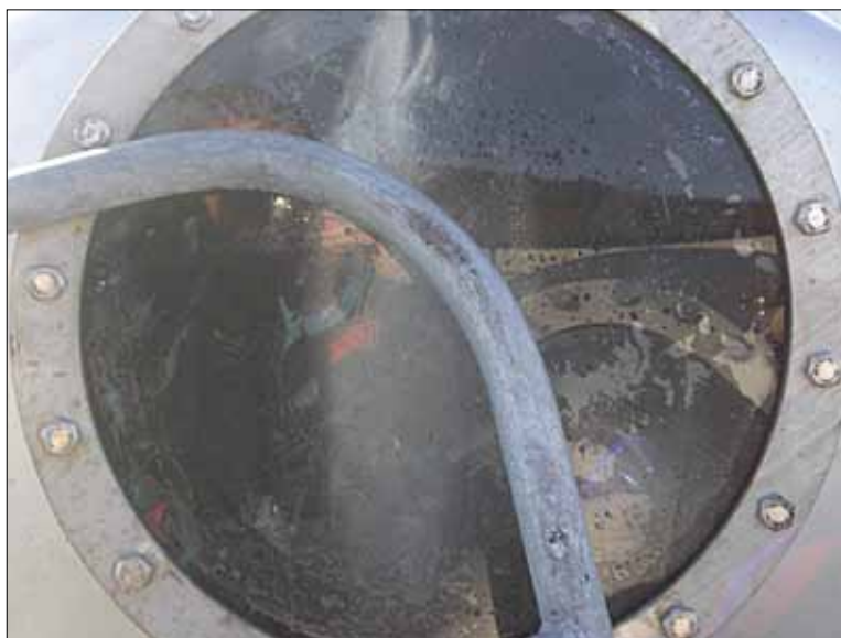
Figur 1.2-4. Fiskens atferd i pumpen kan observeres. Det bør ikke være for mye panikkatferd i pumpen, og det skal ikke ses rødt vann (blodvann).
