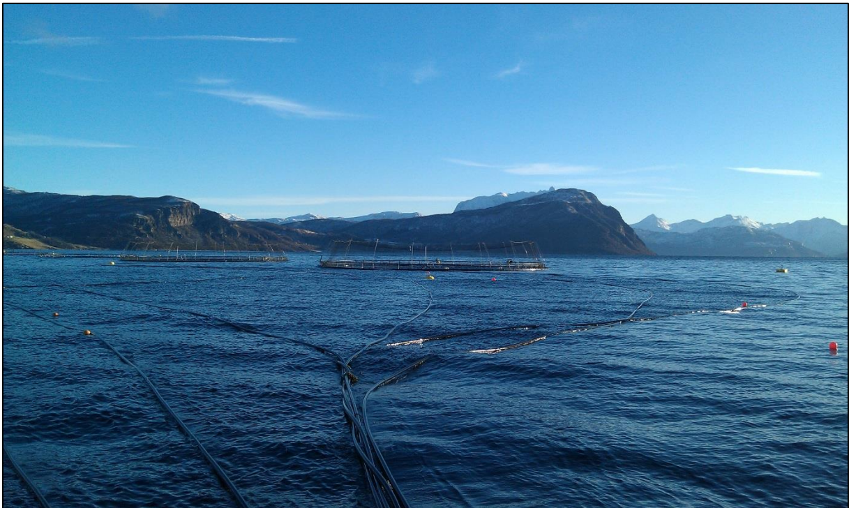
Figur 1.9-1. Sentralfôringsystem med fôringsrør som går fra en sentral fôrflåte til kommersielle oppdrettsmerder. (Foto: C. Noble.)
