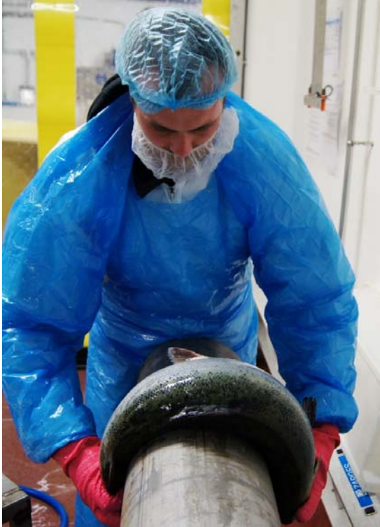
Bilde 8 og 9 Laksen ble bøyd rundt et 10 tommers stålrør på begge sider som vist på bildene.
