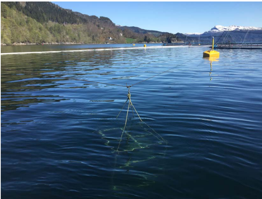
Figur 5. Teinene ble festet i anleggets hjørnebøyer med to tau ned til teinen. Her vises hvordan teinen da kan trekkes bort fra anlegg ved røkting og enkelt settes ut igjen uten å komme i konflikt med anleggets forankringspunkter. Teinen er festet med svivel i toppen for å forhindre snurr på tauet. Ved slik setting kan teinen trekkes bort fra notvegg og anlegg både under setting og haling, noe som forhindrer at teinen berører notvegg.
