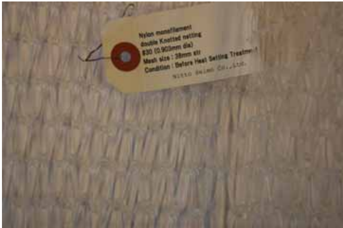
Figur 2. Transparent nylon monofilament lin benyttet til "usynlig kise" i ringnot..
