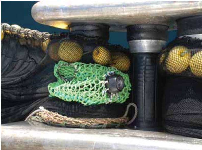
Figur 12. Innhaling av not: observasjonskameraet på tur gjennom triplex.
