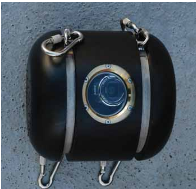
Figur 9a. Observasjonsutstyr til bruk i not. Sony-kamera montert i stålbeholder omgitt av beskyttelseskappe av polyetylen.
