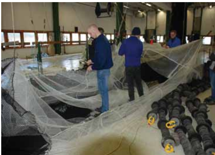
Figur 4. Montering av "usynlig kise" i not, Egersund trålværksted.
