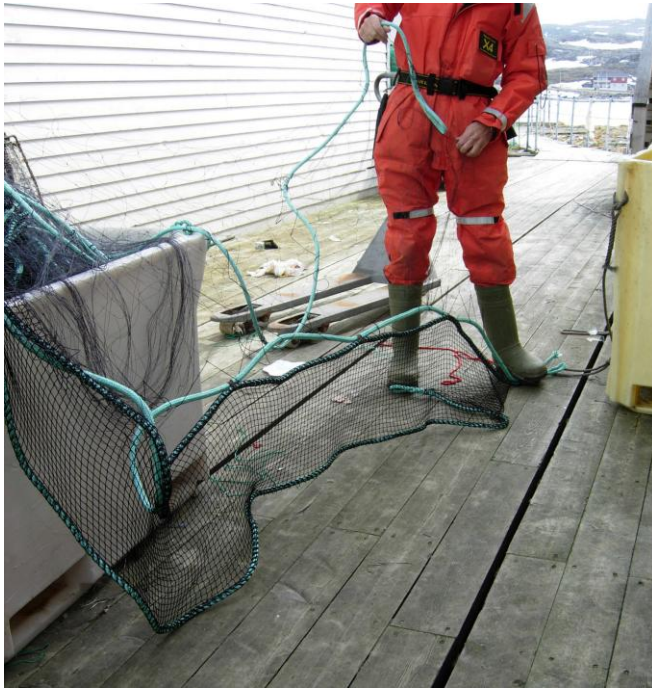
Figur 2. Standardgarn påmontert et 40 cm panel.
