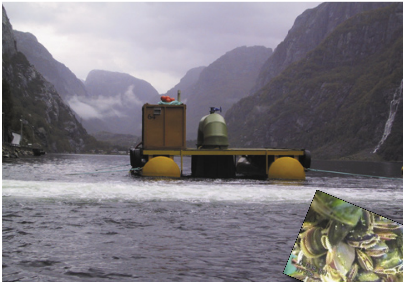
Figur 1: Flåteanlegget i Lysefjorden for kunstig oppstrømning av dypvann.
