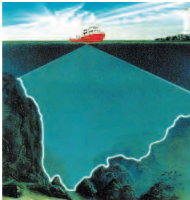
Figur 6.28 Kartleggingen ble foretatt av Sjøkartverkets “Sjømåleren”. Det ble brukt et flerstråle-ekkolodd som sender ut mer enn 100 stråler samtidig. Dette gir et meget detaljert og flatedekkende bilde av havbunnen. Et vanlig “fiskelodd” bruker bare en stråle.
