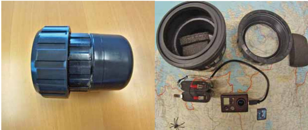
Figur 2. Kamerahus bygget av standard GF deler (venstre bilde). Demontert kamerahus, med kamera, batterier, minnebrikke, etc (høyre bilde).
