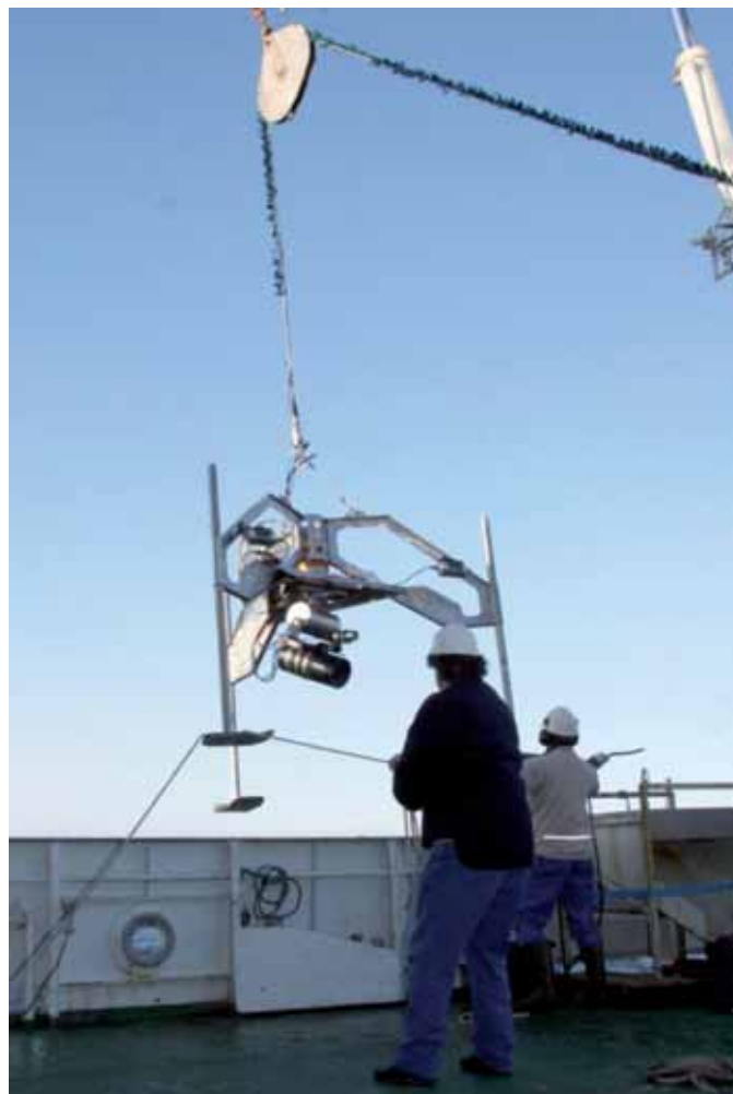
Undervannsfotorigg, som slepes over bunnen for bunnobservasjoner.
