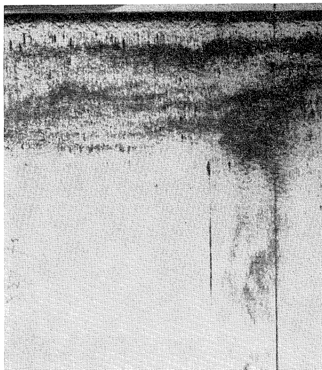
Figur 5. Registrering i 10–40 m av raudåte og ribbemaneter ( Ctenophora ) i Skånevikfjord 30. mai 1968 kl. 1600. SIMRAD EH-lodd, fase 0–125 m styrke 5. Skipets fart 2–3 knop.
