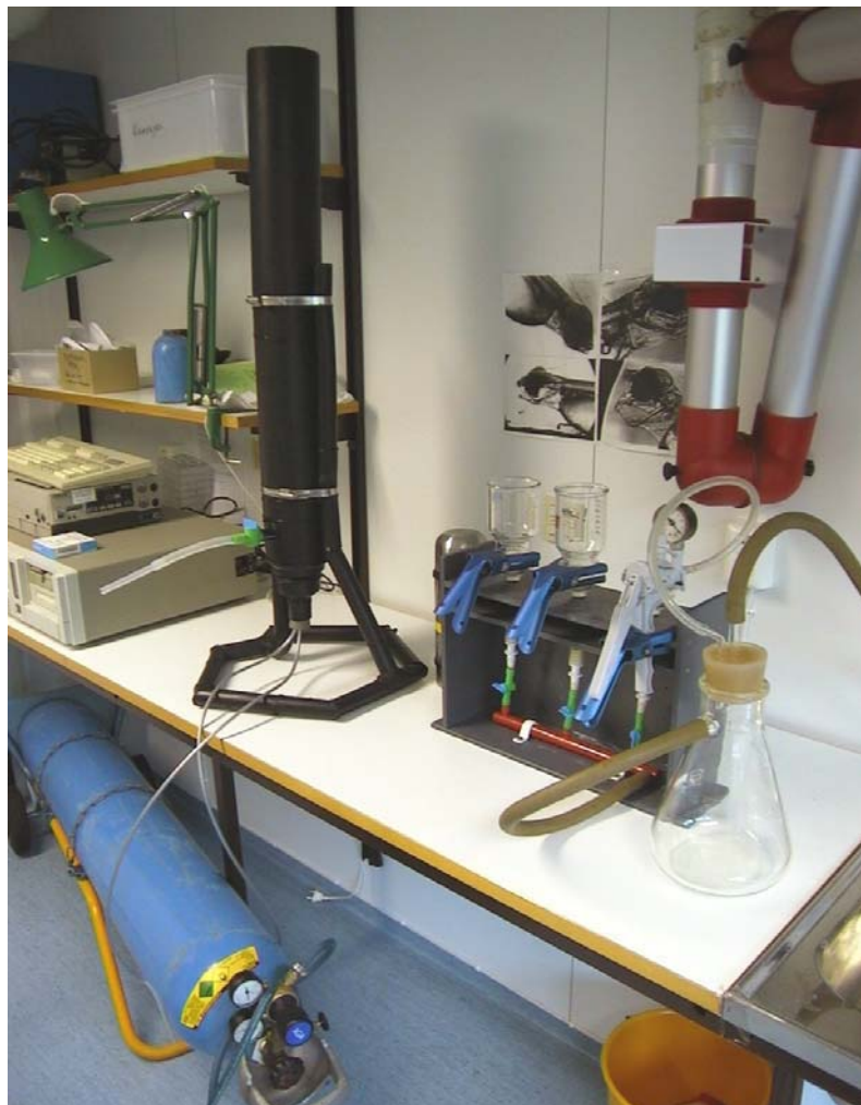
Figur 3. Prøvetakingskolonne for levende oppbevaring av copepodene og filtrerings-enhet for skylling og fjerning av vannoverskudd under prøvetakingen. Column for keeping the copepods alive through the sampling procedure and filter unit for washing and removal of excess water from the samples.
