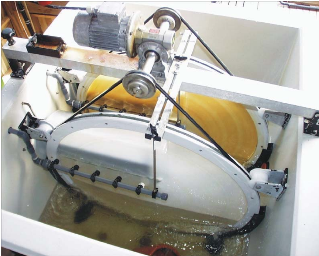
Figur 2. Hjulfilter (UNIK-900) for oppkonsentrering og fraksjonering av copepodene. Wheel filter (UNIK-900) for concentration and fractionation of copepods.
