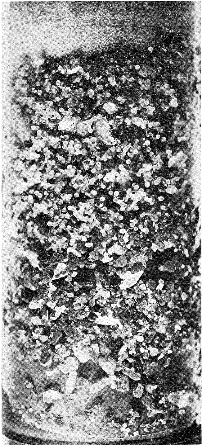
Fig. 7. Prøverør med blanding av egg og singel. [Sampling tube showing a mixture of eggs and gravel]. Foto: K. Hansen.
