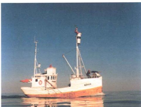
Figur A.8.8. Et tradisjonelt fartøy for fangst av vågehval. Legg merke til den svarte konsesjonsstripa på utkikkstønna og den røde granaten på harpunen i kanonen. Granaten bidrar til umiddelbar avlivning av hvalene.
