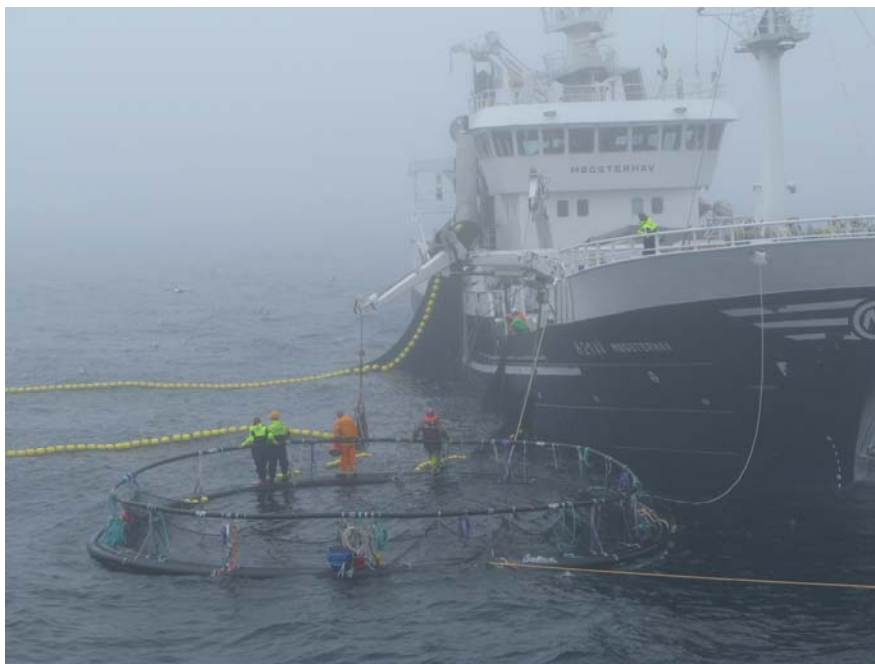
Figur 2. Overføring av sild fra not til merd. Kanalene på nota og merden er benslet sammen og holdes åpen. ( Transfer of herring from purse seine to pen. The channels have been seized together and are held open. )
