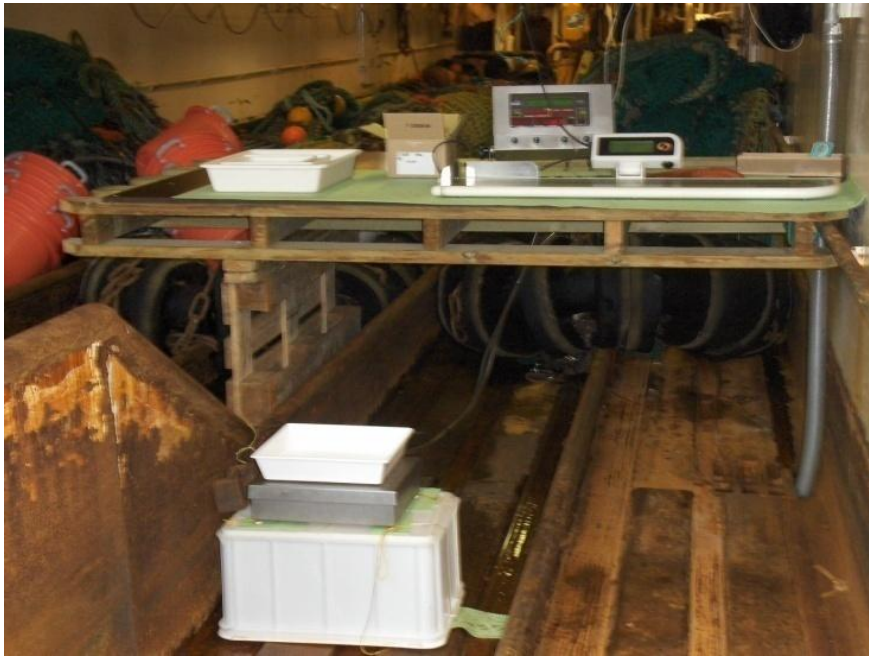
Figur 3. Utstyr for prøvetaking, Fishmeter og vekt ble rigget opp på tråldekk.
