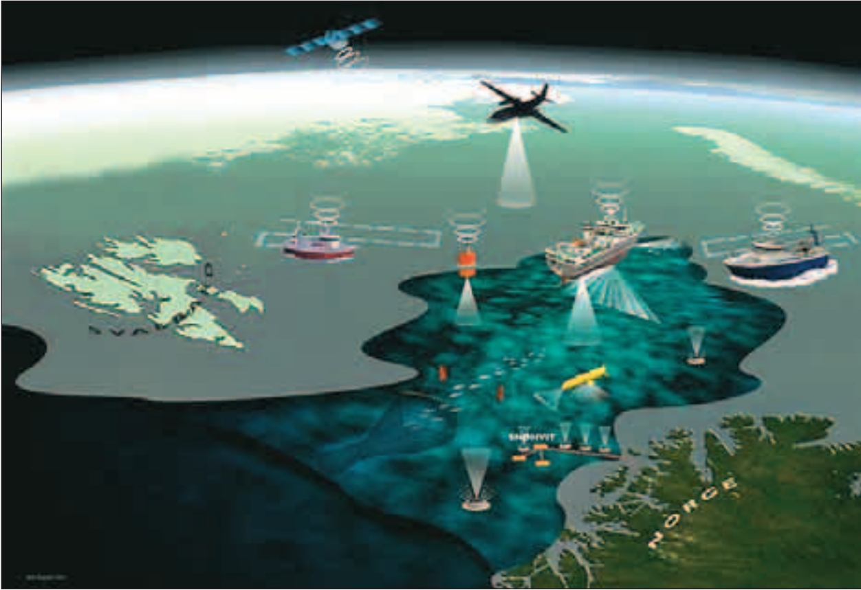
HAVOVERVÅKING: Slik kan havovervåking gjennomføres med felles innsats fra fiskeri, oljeindustri og forskning. Her samler sensorer i oljeindustriens infrastruktur inn data sammen med fiskebåter og forskningsfartøy.
