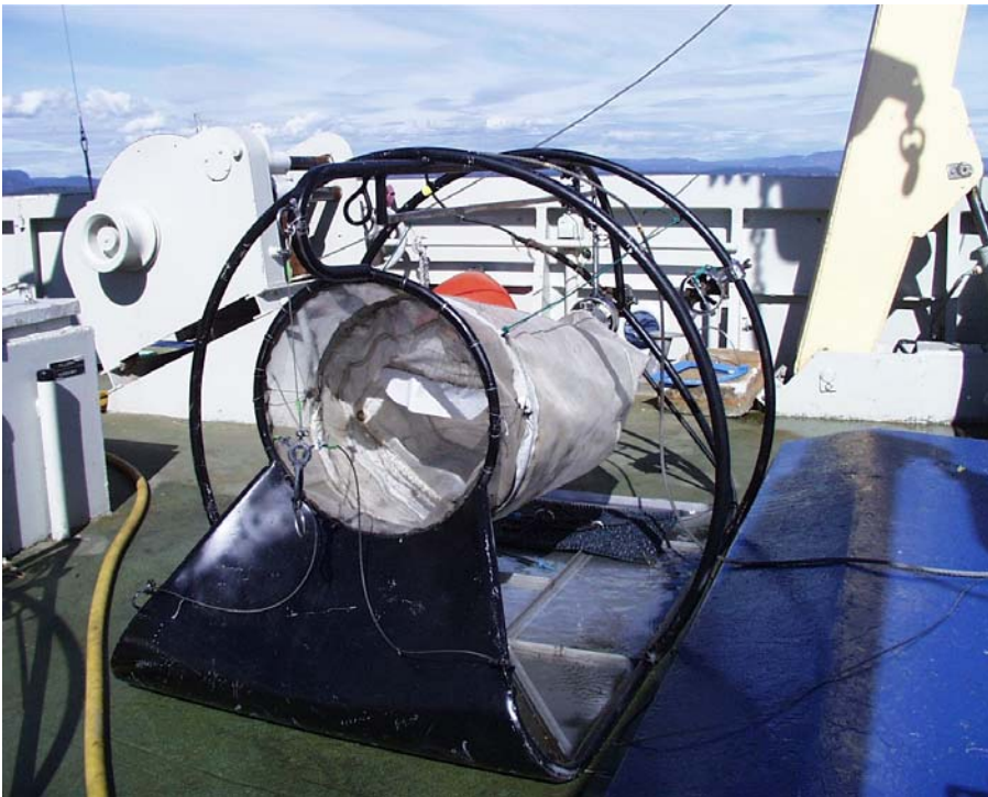
Figur 44. Bunnslede brukt til innsamling av dyr (hyperbenthos) som lever rett over bunnen.
