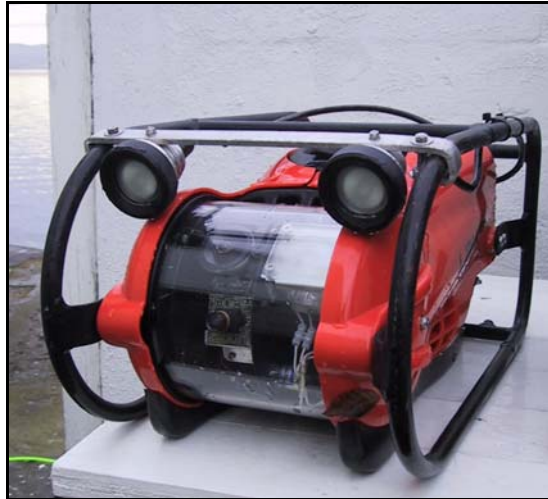
Figur 80. NIVAs fjernstyrte ubåt (ROV) er et godt egnet redskap til undersøkelse og kartlegging av marine habitater i indre Oslofjord. Den vil bli brukt i Fagrådets videre kartlegging av Bunnefjorden. (Foto: Mats Walday)
