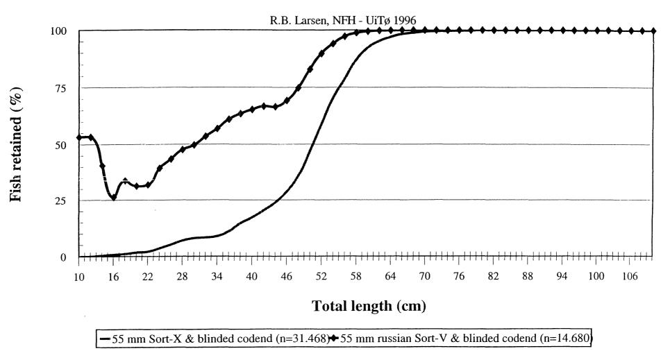
Fig. Seleksjonskurver for torsk under forsøk i norsk trål med 55 mm Sort-X og russisk 55 mm Sort-V. Bjørnøya, September 1995.
