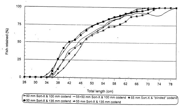
Fig. 3.11. Seleksjonskurver for blåkveite under forsøk med Sort-X, Fugløybanken-Tromsøflaket, nov. '94
