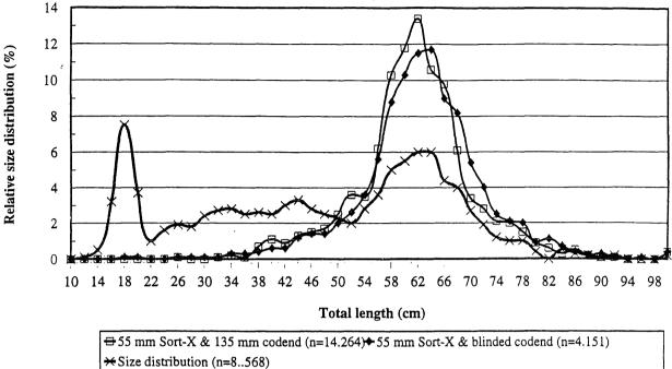
Fig. Relativ størrelsefordeling for torsk under forsøk med 55 mm Sort-X. Bjørnøya, September 1995.
