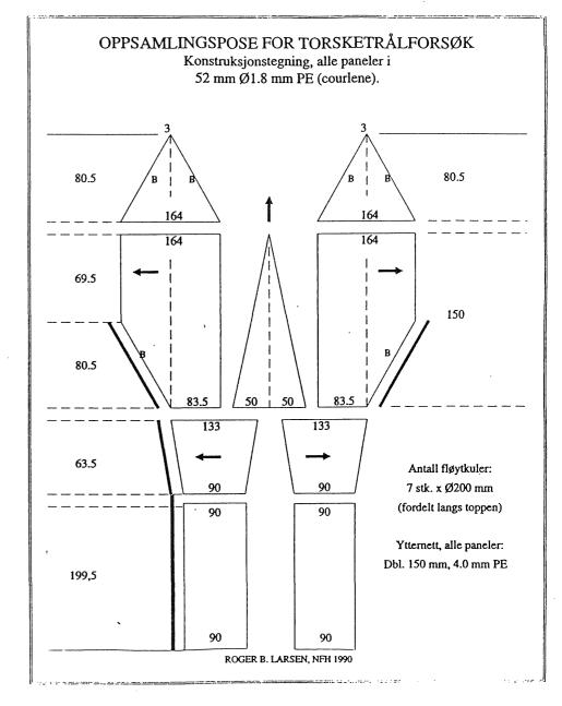
Figur 5: Konstruksjon av oppsamlingspose for seleksjonsforsøk.
