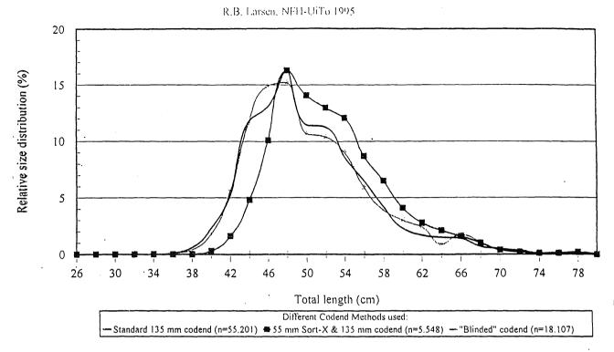
Fig. 3.16. Relativ størrelsefordeling for blåkveite under forsøk med Sort-X, Fugløybanken-Tromsøflaket, nov. '94
