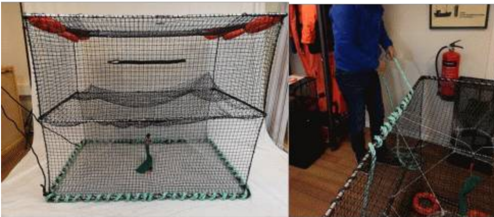
Montering av blytau på tokammerteine (bildet over til høyre). Ferdig montert rundt hele bunnrammen (bildet over til venstre)
