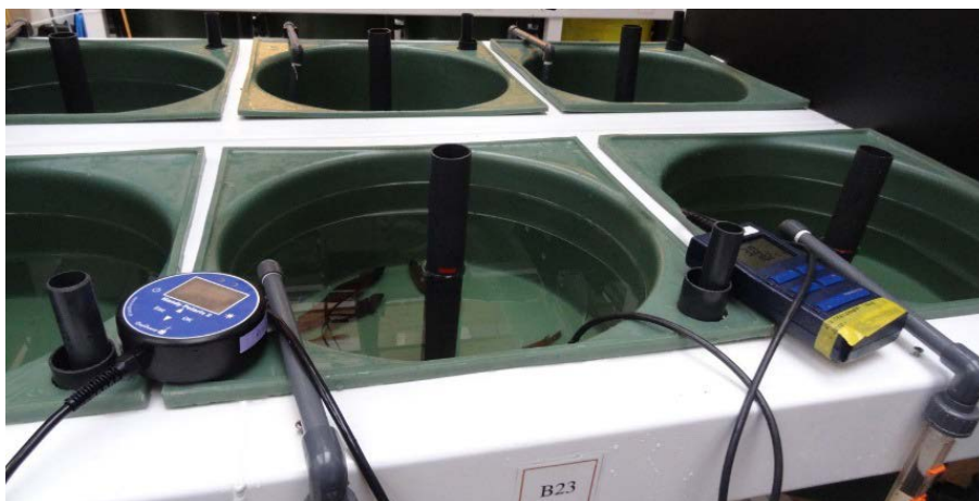
Figur 18. Måling av oksygenmetning (til venstre) og konduktivitet/saltholdighet (til høyre) i behandlingskar med berggylder. Foto: Reidun Bjelland.
