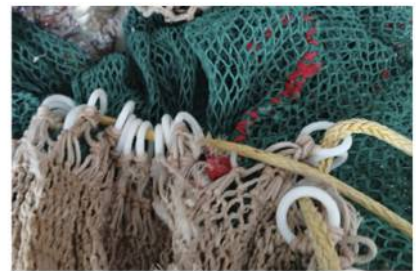
Bilde 20. Stroppene som festes til leistau er begge intakt (venstre). Ringene er deformert (midten). P-ledd mellom stropper og ringer er slitt av (antatt bruddstyrke p-ledd 1000 – 1500 kg). Ringene som rundstroppen går gjennom er intakt (høyre).
