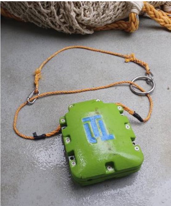
Bilde 7. Festemåter for mekanisk utløser.
