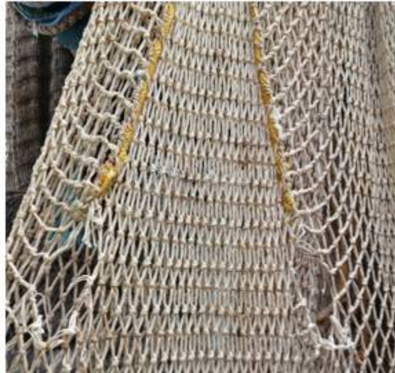
Bilde 19. Selve spaltene (topp og sider) og tauene rundt har holdt seg (bilde til venstre, men ved enden på V-ene på spissene slites hull. Det samme gjelder for alle de tre spaltene.
