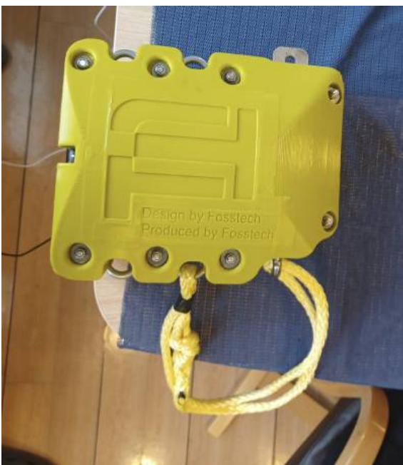
Bilde 8. Festemåte for elektronisk utløser.
