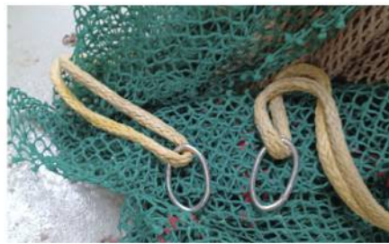
Bilde 20. Stroppene som festes til leistau er begge intakt (venstre). Ringene er deformert (midten). P-ledd mellom stropper og ringer er slitt av (antatt bruddstyrke p-ledd 1000 – 1500 kg). Ringene som rundstroppen går gjennom er intakt (høyre).
