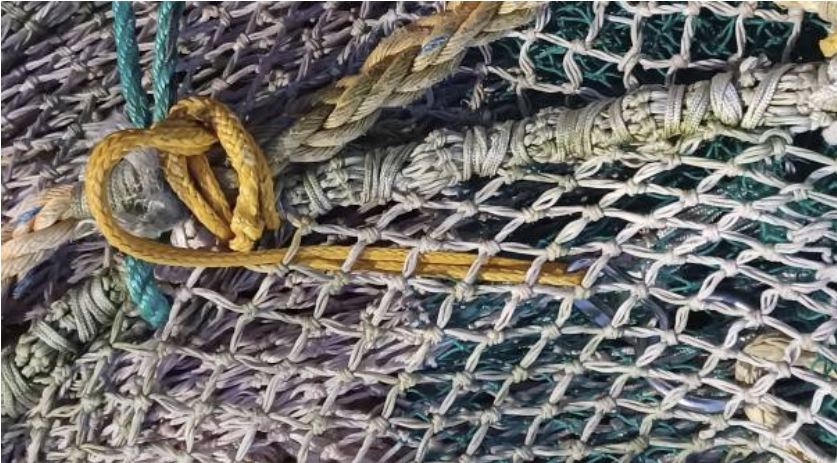
Bilde 4. Dyneema tau festet med p-ledd til stårling. Rundstroppen på fiskelåsen går gjennom stårlingen.
