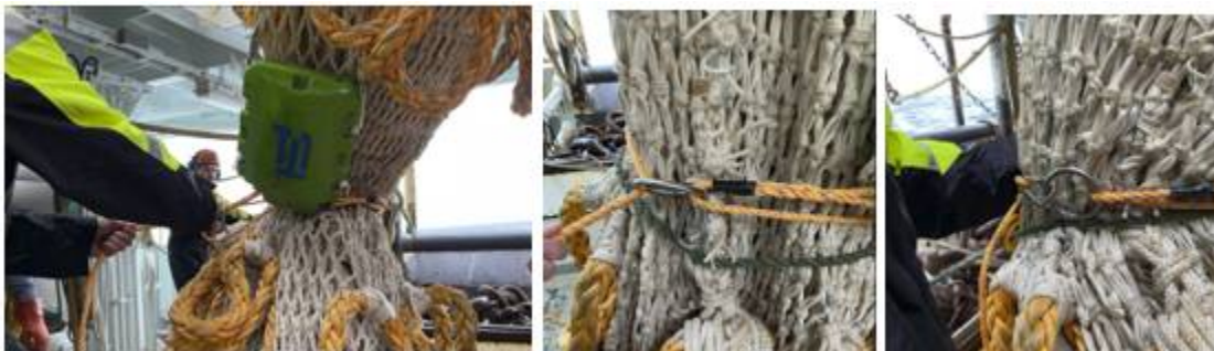
Bilde 6. Montering av utløser. Etter at utløseren var festet på sekken ble en stropp strammet rundt for å knipe sammen sekken. Deretter ble utløserstropp strammet rundt sekken, målt og spleist.
