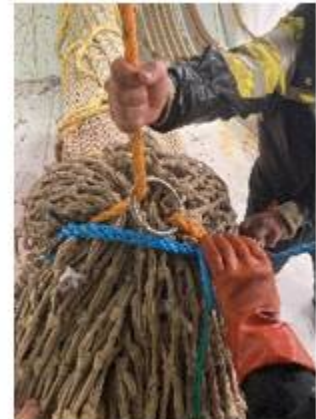
Bilde 1 : venstre - knytt over med 10 mm nylon, midten - knytt over med 12 mm blå Danline, høyre - forberede før overbinding.
