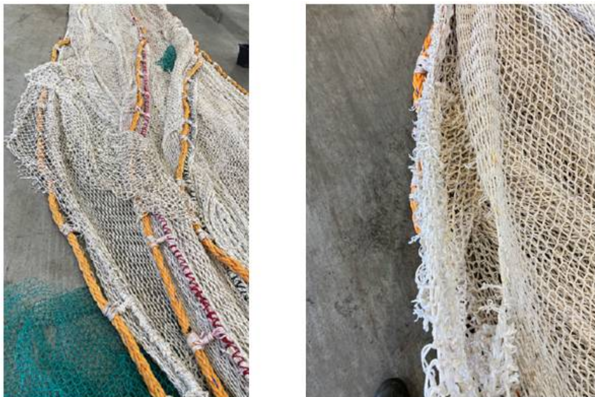
Bilde 2 : viser skade på fangstbegrensningssystemet etter sprenging ved innhiving i hal nr. 2.
