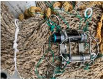
Bilde 1 : venstre - knytt over med 10 mm nylon, midten - knytt over med 12 mm blå Danline, høyre - forberede før overbinding.
