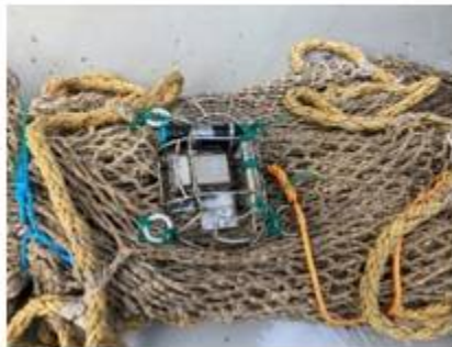
Bilde 1 : venstre - knytt over med 10 mm nylon, midten - knytt over med 12 mm blå Danline, høyre - forberede før overbinding.
