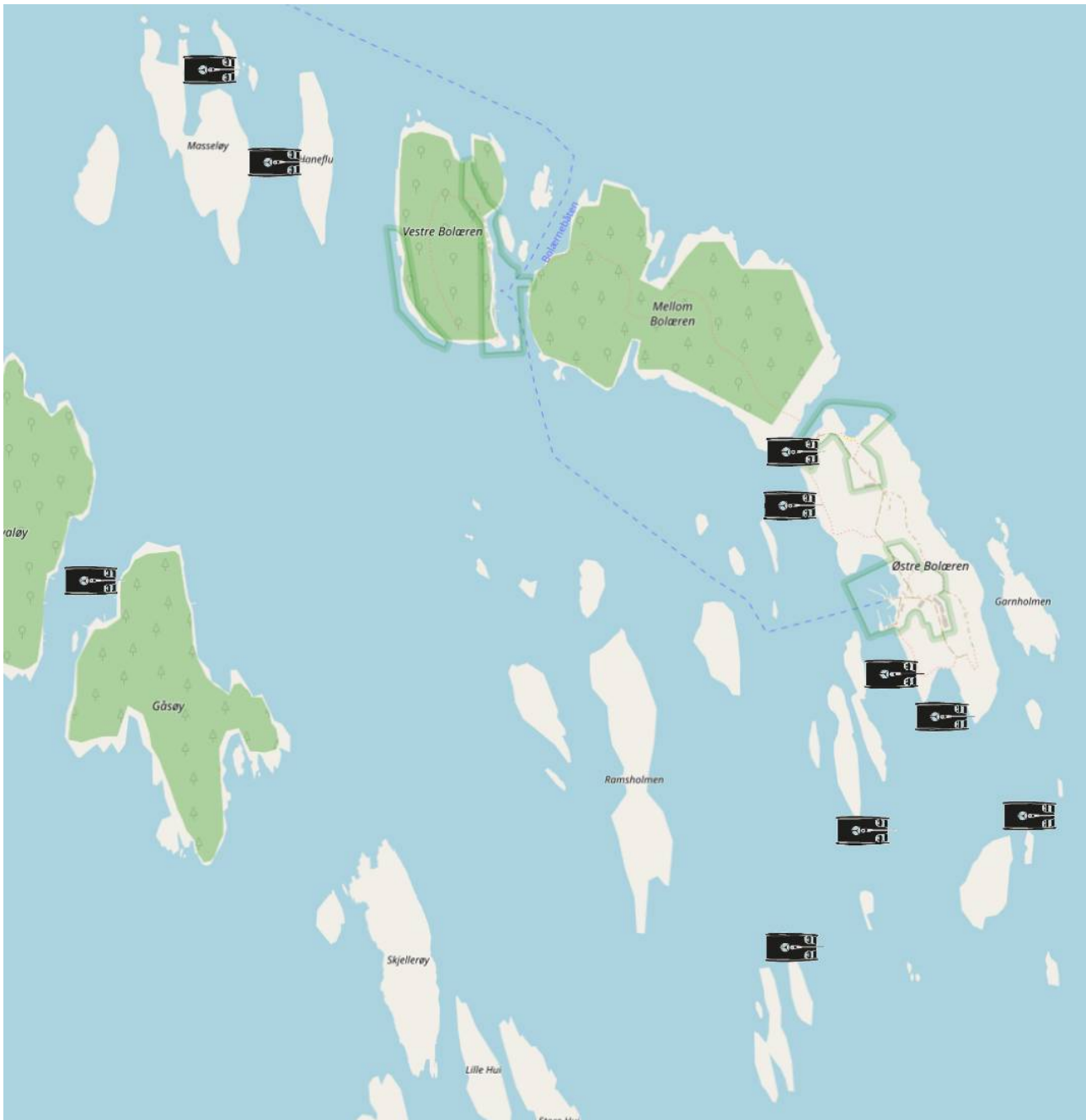
Figur 7. Stasjonskart for 10 Undervannsdroner-transekt ved Boløerne i 2019. Transektene ble tatt i ulike habitat (hardbunn, ålegress, tangsamfunn, sandbunn og mudderbunn) på dyp mellom 1 og 10 m. Transektlengdene var på 50-150 m.
