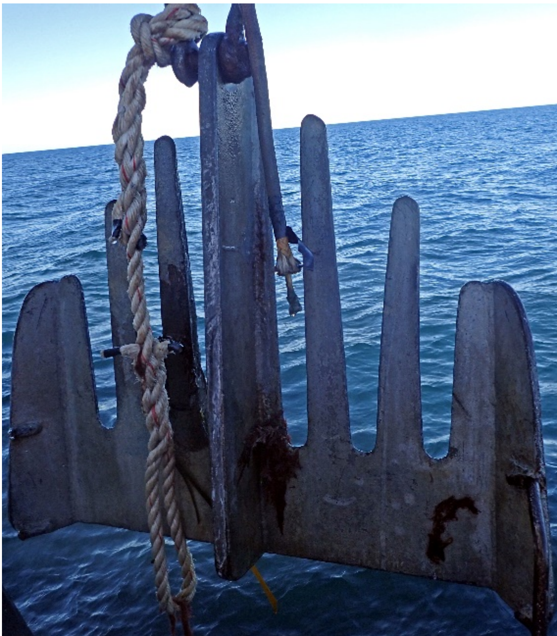
Figur 4. Tareskrape i stål (ca 60 cm bred), benyttet til innsamling av stortareplanter.
