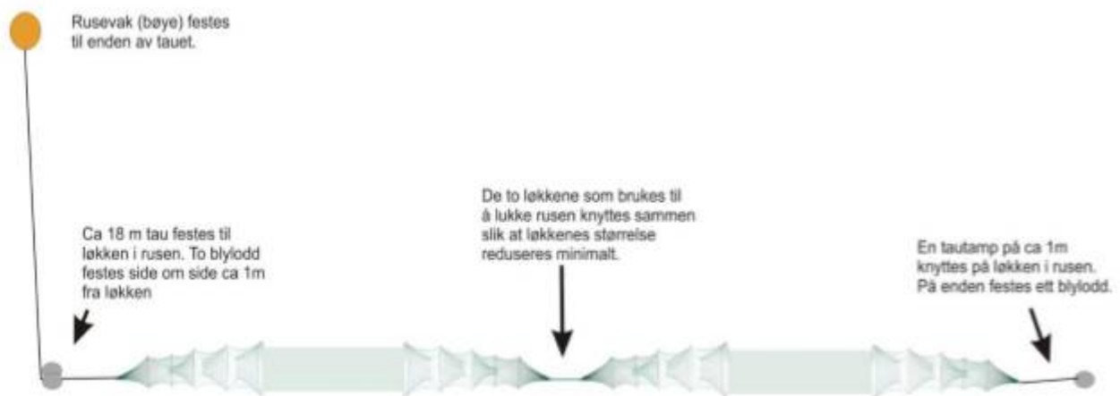
Figur 8. Doble åleruse: Fra venstre; ett rusekammer og 3 kalver, så et ledegarn og 3 kalver og et rusekammer. Andre halvdel er et speilbilde av første (fra van der Meeren, 2018).
