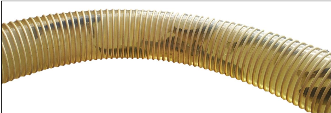
Figur 1.2-3. Smoltens atferd under pumping kan overvåkes gjennom den gjennomsiktige slangen. (Foto: Å. M. Espmark).
