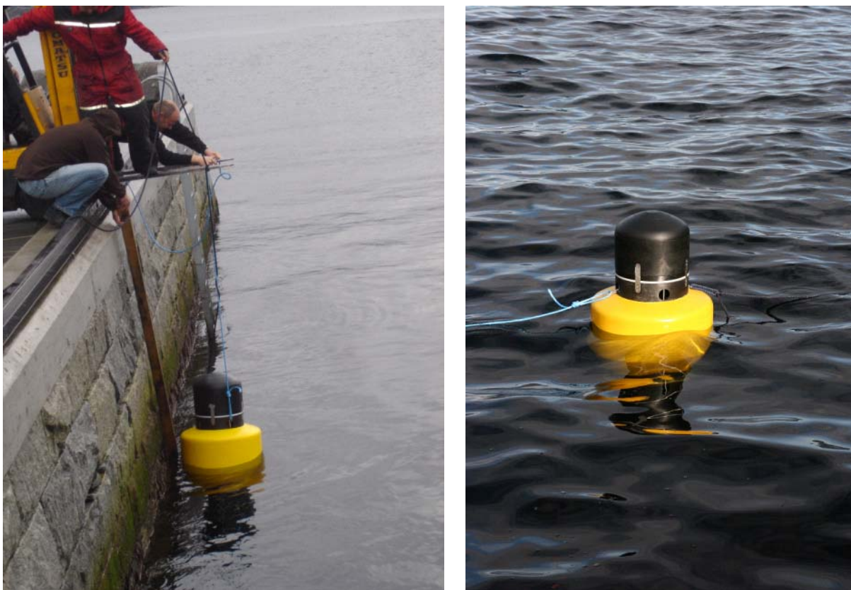
Figur 9 Disse bildene er fra første uttesting av stakebøyen sin flyteevne.
