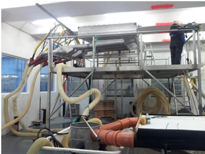
Figur 1.2-1. Rør-bøy kan forårsake skade på fisken. (Foto: Å. M. Espmark).
