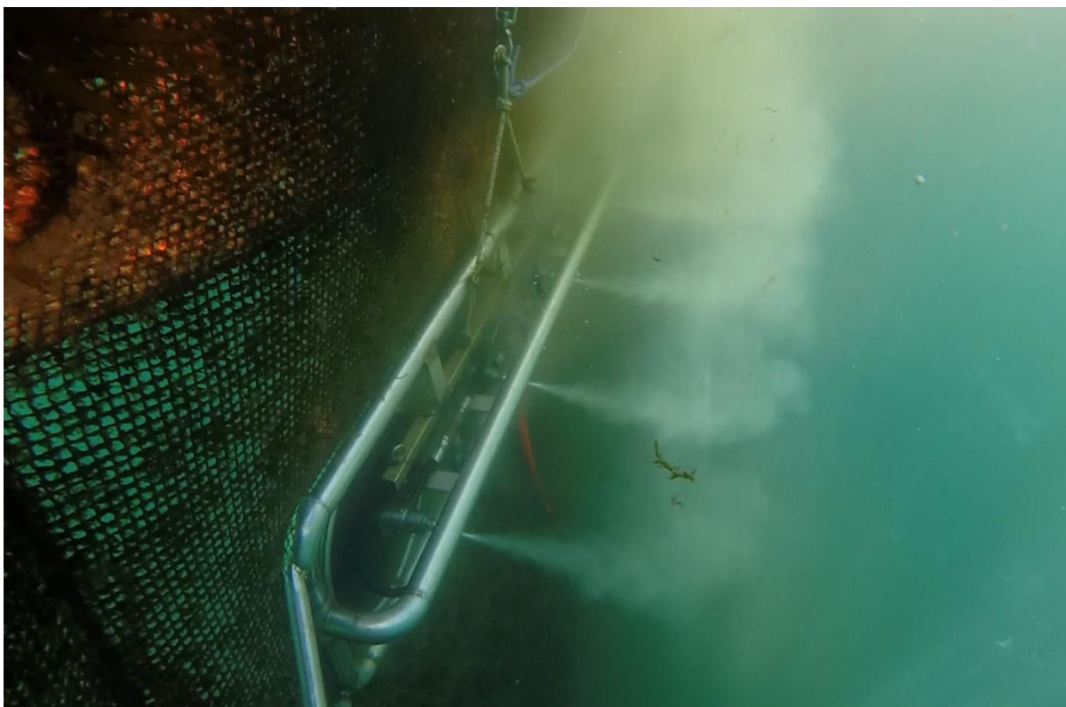
Figur 2.2.4-2. Eksempel på en notrengjøringsrigg fra AKVA med 4 rengjøringshoder under bruk. (Foto gjengitt etter tillatelse av N. Ribeiro, 2016).
