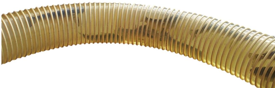
Figur 1.2-3. Smoltens atferd under pumping kan overvåkes gjennom den gjennomsiktige slangen. (Foto: Å. M. Espmark).
