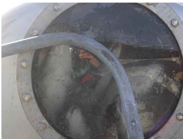
Figur 1.2-4. Fiskens atferd i pumpen kan observeres. Det bør ikke være for mye panikkatferd i pumpen, og det skal ikke ses rødt vann (blodvann). (Foto: Å. M. Espmark).
