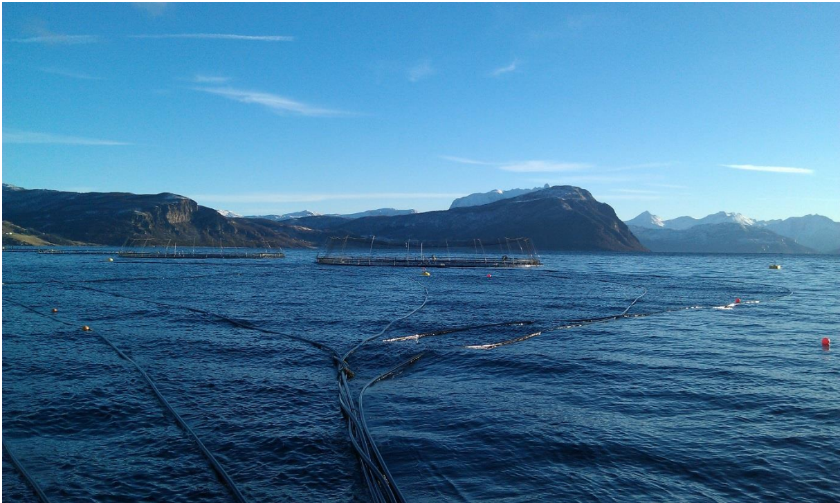
Figur 1.9-1. Sentralfôringsssystem med fôringsrør som går fra en sentral fôrflåte til kommersielle oppdrettsmerder. (Foto: Chris Noble.)
