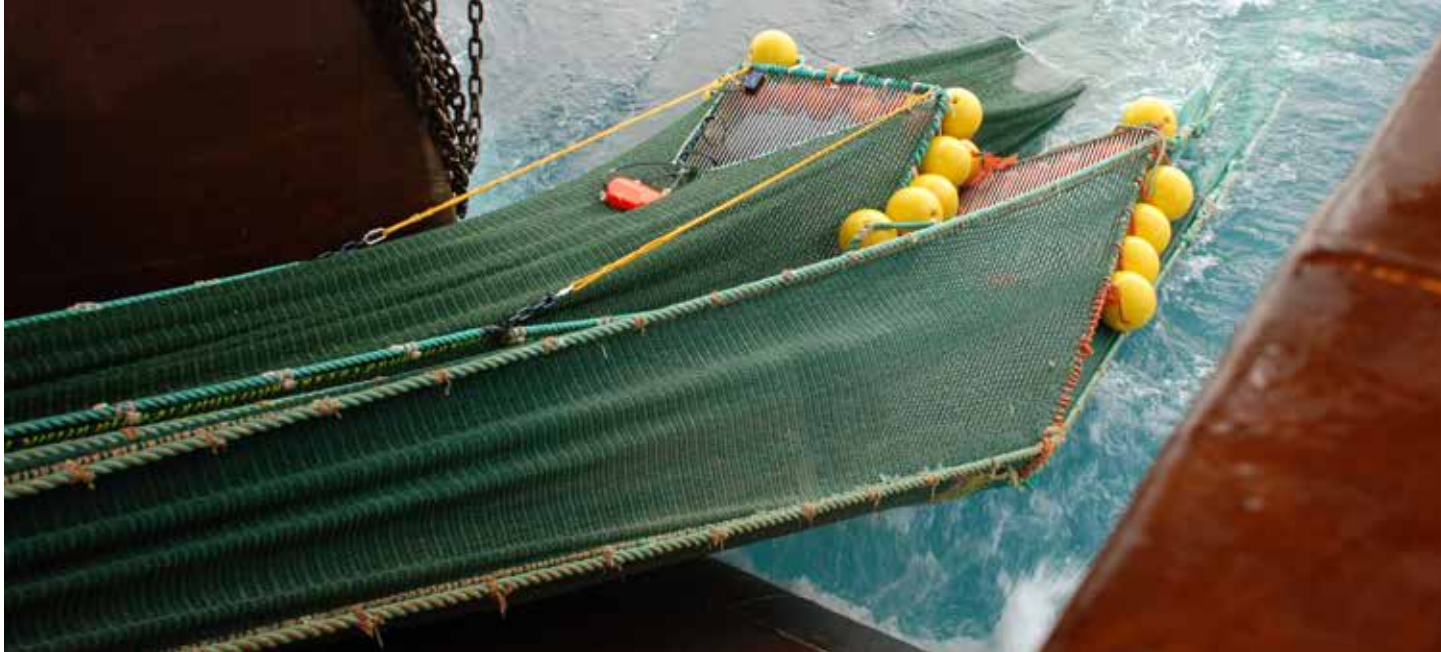
Inntak av dobbeltrål om bord på MTr "Hermes". Forsøk med sammenligning av rekerist montert i to forskjellige forlengelser. Styrbord-trål med topanels forlengelse og støttetau på rist, babord trål med firepanels forlengelse uten støttetau.
