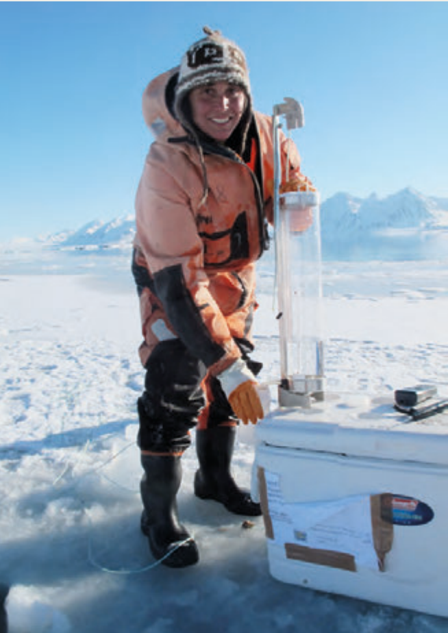
Figur 1. Det tas vannprøver under isen. Til prøvetakingen brukes en vannhenter. Taking water samples under the ice, a water collector is used.
