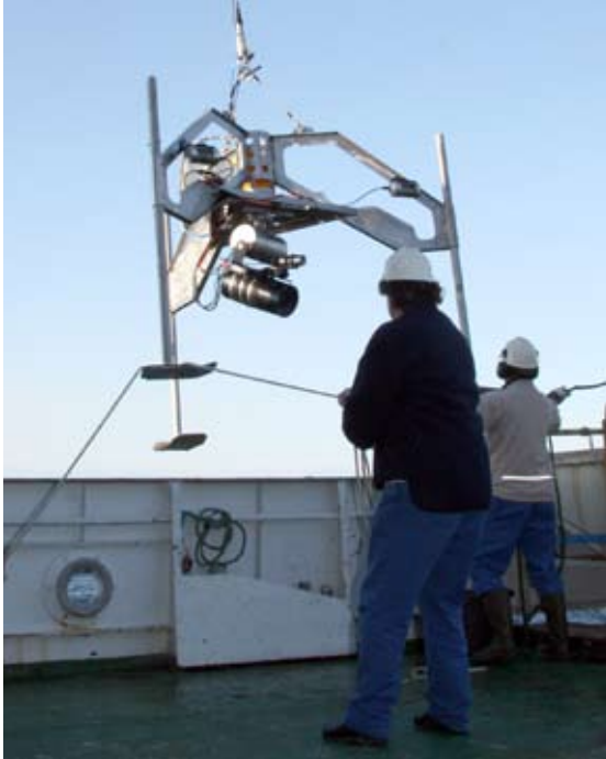
Figur 2. Videoriggen Campod er utviklet spesielt for MAREANOs behov og er et viktig redskap i kartleggingen.
