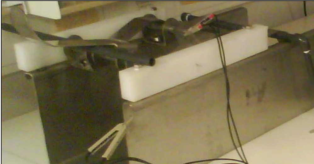
Figur 2: Praktisk småskala forsøksoppsett ved elektrobedøving. Det brukes isolerende plastrør for å heve sko/fingre som ikke brukes, merk også plassering av tilkoblingsklemmer for måling av spenning.
