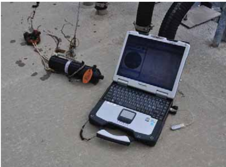
Figur 5. Lyttebøye og PC til uthenting av data frå lyttebøyen.
